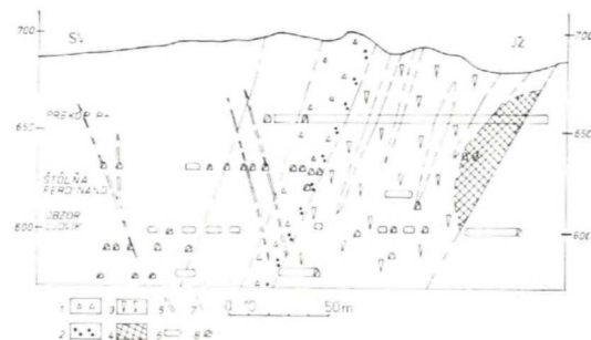
Obr. 2. Priečný geologický rez ložiskom Šturec. 1 — andezitové brekcie, 2 — intenzívna silicifikácia a K metasomatizácia, 3 — kremenná žilovina, 4 — vyťažená kremenná žilovina, 5 — protisklonné žilky, 6 — banské diela — prekopy, 7 — tektonické línie, 8 — staré banské diela
